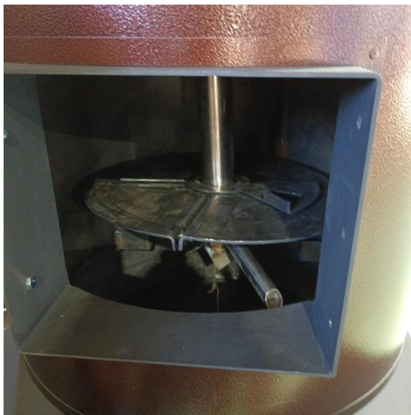
Рисунок 5.6 – Установка экранов-ограничителей топки на новые котлы «Liepsnele Arctic» на заводе ООО «ЯКЗ»
