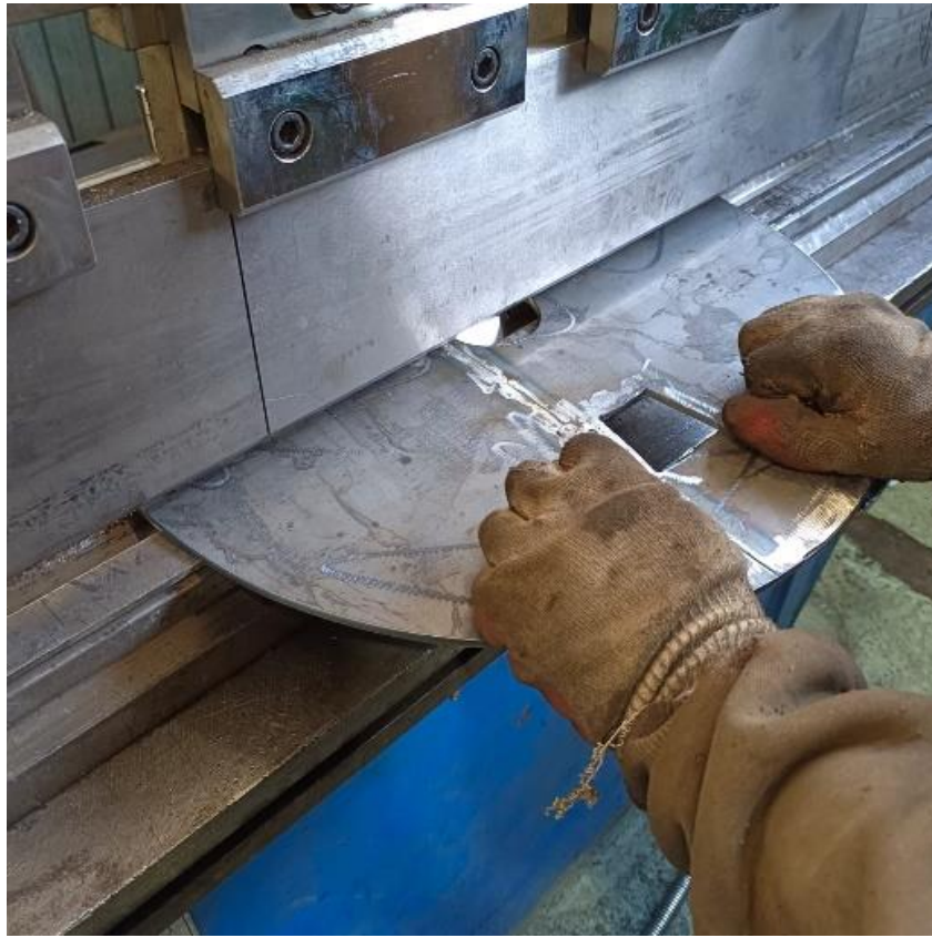
Рисунок 5.7 – Формование устройства на механической гильотине
