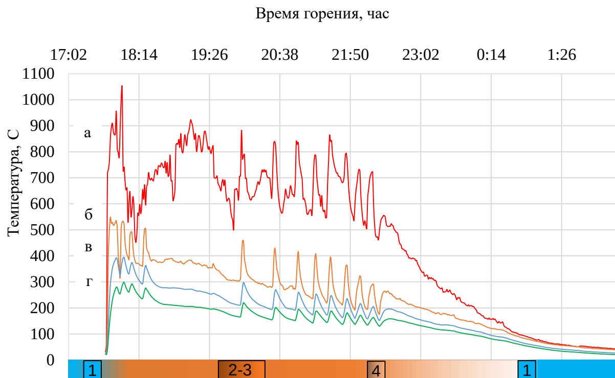
Рисунок 2.11 – Процесс горения котла на 1 закладке дровяного топлива, где: а) температура горения в топке, на месте подачи воздуха, ^\circ\text{C} , б) температура дымовых газов на выходе с топки котла, ^\circ\text{C} , в) температура дымовых газов в середине дымохода, h=3,5 м, ^\circ\text{C} , г) температура дымовых газов в устье дымохода, h=7,0 м, ^\circ\text{C}
