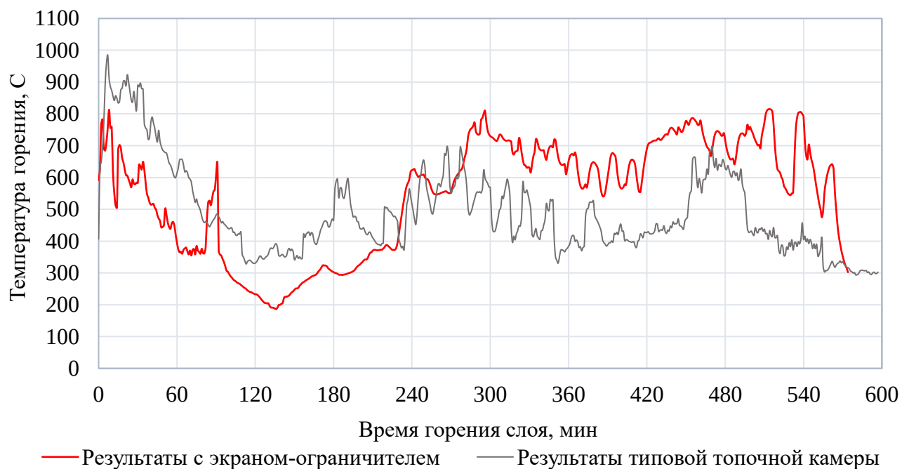
Рисунок 4.5 – Сравнительный график показателей температуры горения в топке
