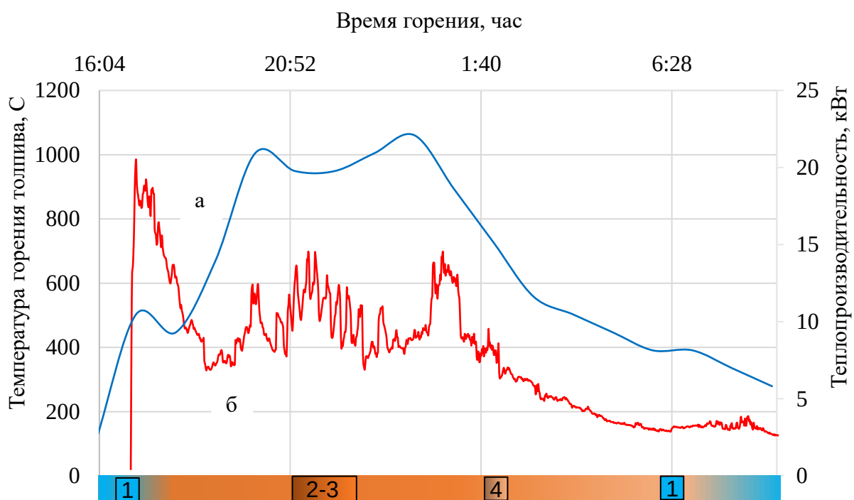
Рисунок 2.12 – Процесс горения котла на 1 закладке бурого угля, где: а) тепловая производительность котла, кВт, б) температура горения топлива, °C
